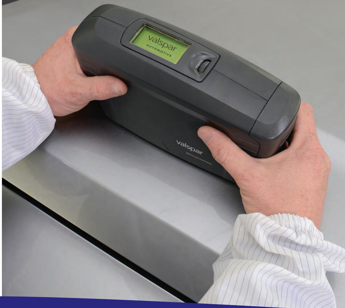
**Спектрофотометр Valspar** – уникальный инструмент, разработанный специально для точного определения рецепта цвета и быстрого подбора идеальной альтернативы.
