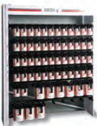
Вертикальная краскосмесительная установка на 64 места, позволяющая разместить 48 литровых и 16 шт. 3,5-литровых емкостей. Обеспечивает равномерное перемешивание компонентов, оборудована автоматическим таймером отключения. Габаритные размеры: 1660x2200x492 мм.
